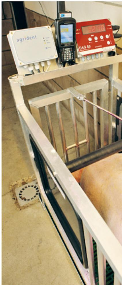
**Wiegedaten übernimmt das System automatisch. Dazu wird das Lesegerät mit der Waage gekoppelt. Foto: Heil**
