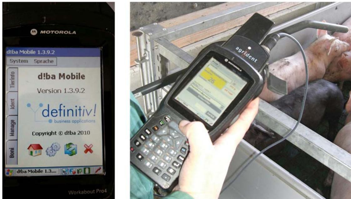
Abb. 3: Lesegerät Motorola Psion WAP4; d!ba mobile und Reader bzw. Stabantenne AIR 300 agrident
